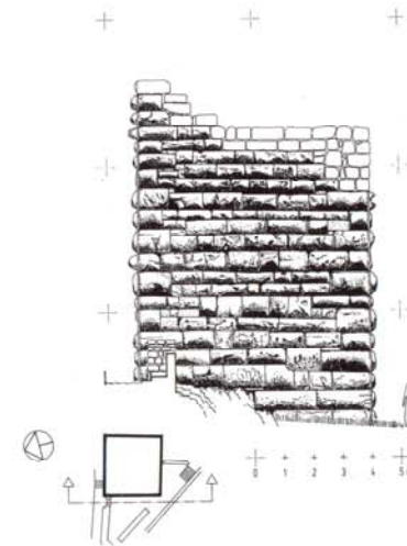
Abb. 4: Prallbuckelquader am Bergfried der Ruine HOHENGUNDELFINGEN (bei Münsingen, Kreis Reutlingen, Reg.bezirk Tübingen in BW). Westseite, im oberen Bereich jüngere Ergänzungen.
